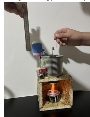
Рис.17. Замер амплитуды хода поршня.
